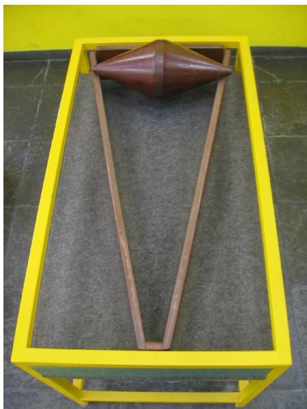
Figura 16 – Plano inclinado com duplo cone. Cones que "sobem" a rampa. Experimento contra-intuitivo que apresenta o conceito de equilíbrio mecânico e Centro de Massa.
