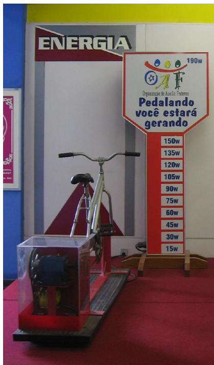
Figura 27 – Bicicleta elétrica. Princípio de funcionamento de um dínamo. Transformação de energia mecânica em elétrica.
