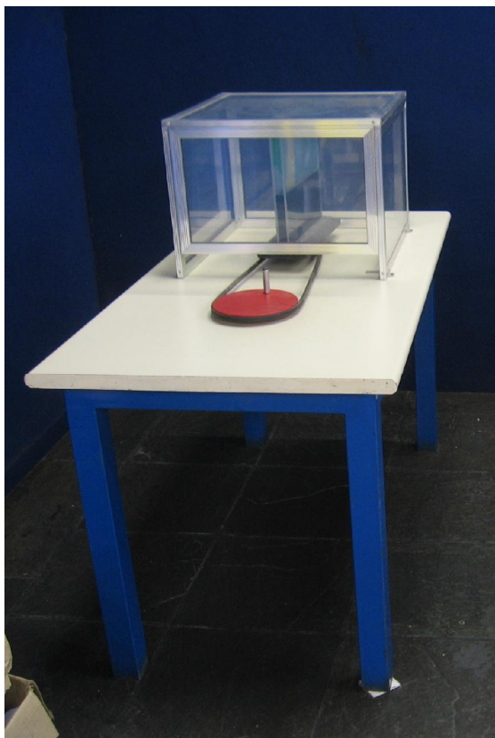
Figura 31 – Aquário. Fluido deslocado por centrifugação, formando uma figura cônica.
