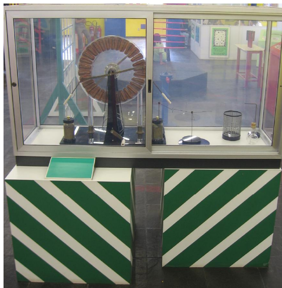
Figura 54 - Máquina de Wimshurst. Gerador eletrostático por indução (não por atrito) gerando alta tensão entre 2 terminais esféricos, utilizado neste caso para carregar duas garrafas de Leyden. Tais garrafas foram muito populares e úteis no desenvolvimento da eletricidade. As cargas acumuladas nesses terminais se descarregam gerando faíscas elétricas. Ela foi inventada por volta de 1882 pelo engenheiro inglês James Winshurt (1832 -1903) 1 .
