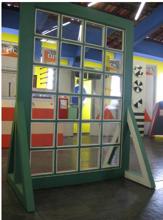
Figura 44 – Janela de vidros e espelhos. Um conjunto de vidros e espelhos alternados onde os temas de reflexão, semi-reflexão e refração da luz são abordados.
