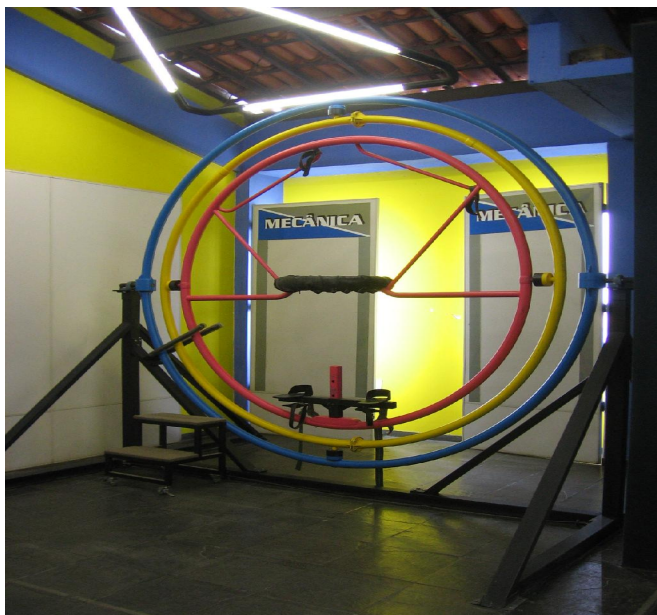
Figura 46 – Girotec. É um suporte fixo com três círculos concêntricos, em que uma pessoa de até oitenta quilos fica presa pelos punhos e pés e é girada em várias direções. Com isto, simula-se a sensação de ausência de gravidade.
