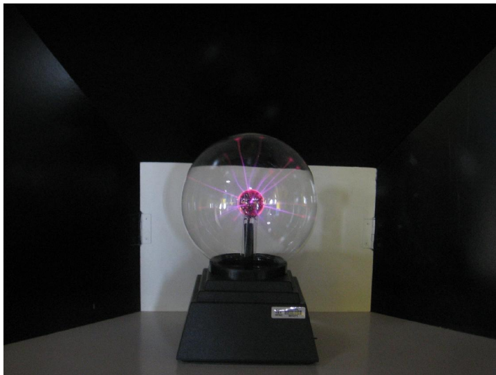
Figura 43 - Globo de raios. Similar a um capacitor esférico.
