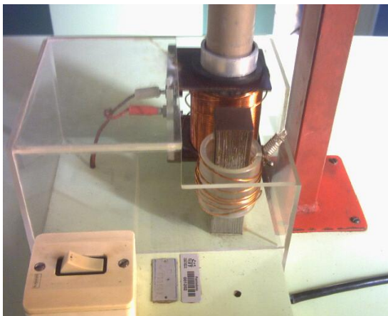
Figura 7 – Visão da parte central superior do Levitador Magnético.
