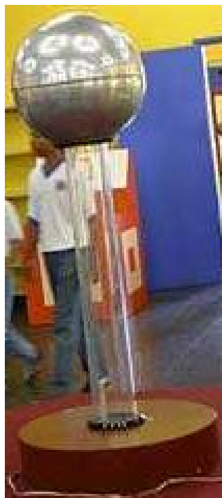
Figura 53 – Gerador de Van Der Graaf . Efeito eletrostático. Acúmulo de carga numa esfera condutora.
