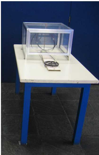
Figura 32 – Forma da Terra/Globo. Força centrífuga, agindo em material com certa elasticidade.
