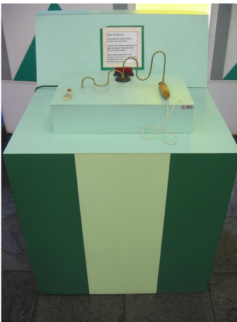
Figura 4 – Teste de Nervos. O princípio de funcionamento de um circuito fechado e aberto.
