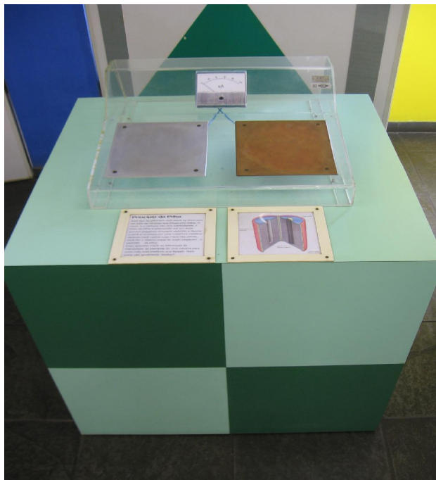
Figura 1 – Princípio da Pilha. Este equipamento produz uma corrente elétrica, que é medida pelo amperímetro, ao se colocar as duas mãos suadas sobre as placas.
